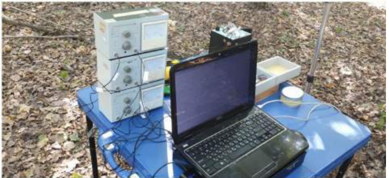
Фото 3 Обладнання калібрується для виміру вїбрації 19.09.2024
