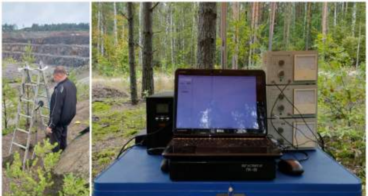
Фото 9 Зліва обладнання для вимірювання шуму (шумомір Октана 1104 на штативі з вітрозахистом ВdK УЛ0682) на відстані 300м від вибуху; справа обладнання для запису вібрації від вибуху (безперервник, АЦП, ноутбук, віброметр M&M 1766)
