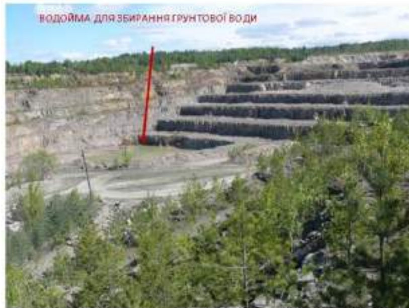
Рис. 1.16 – Нижній рівень на території кар'єру, глибина 100 м. Червоною стрілкою показано водойму для збирання ґрунтової води, яка у подальшому піднімається на поверхню і через систему водойм-відстійників надходить до лісового струмка за межі території підприємства ТОВ «Вирівський кар'єр»
