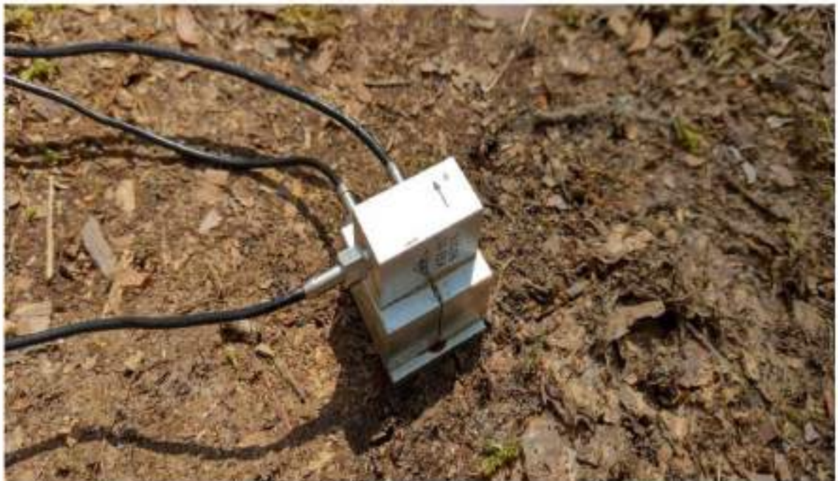
Рисунок 1 Фото акселерометру KB11 змонтованого на ґрунті для вимірювань вібрації у трьох напрямках
